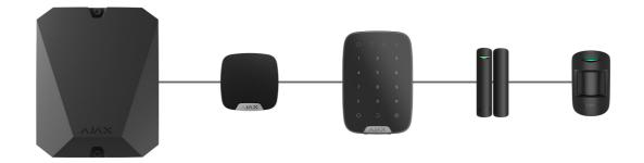
Lorsque vous utilisez la topologie **Linéaire**, veillez bien à installer une résistance de terminaison de  $120~\Omega$  à l'extrémité de la ligne (incluse dans le kit de la centrale). La résistance de terminaison est connectée aux bornes de signal du dernier détecteur de la ligne.
